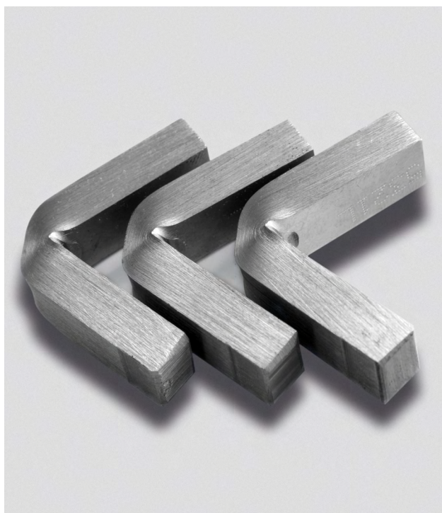
Schlagbiegeproben (gehärtet und angelassen auf 44-46 HRC) nach Prüfung im 450J Pendelschlagwerk
